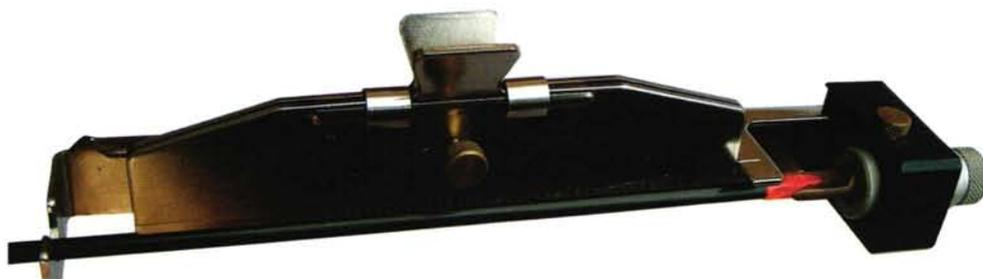
6 ) Tourner le support d'encoche d'un cran et recommencer la procédure à partir de 3) à 5) pour coller les deux plumes poules.
