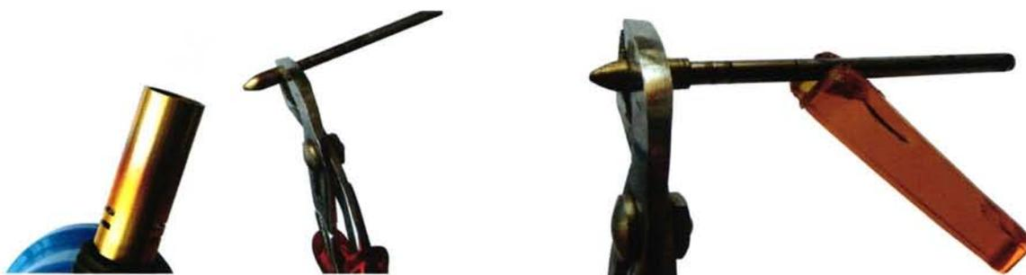
2 ) Introduire délicatement l'insert dans le tube en gardant l'axe de l'insert dans celui du tube, et appuyer fermement jusqu'à complète introduction, attendre quelques secondes avant de relâcher pour assurer le maintien du montage.
