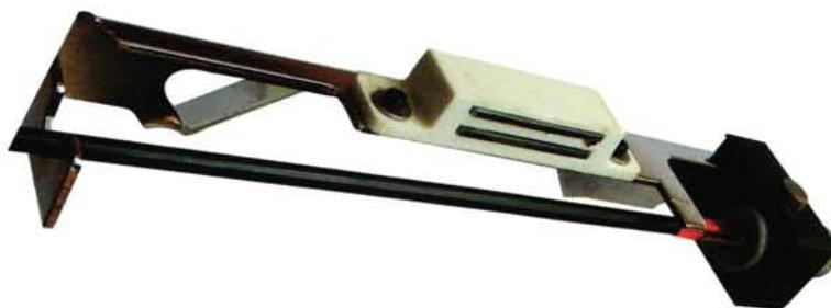
3 ) Mettre la plume coq dans la pince avec un écart suffisant pour permettre le positionnement des doigts sur la corde de l'arc sans toucher les plumes.
