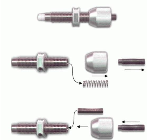
Le bouton pression (BERGER button) dispose d'un ressort permettant le mouvement latéral de la flèche. Quand il est correctement réglé, le BERGER va éviter à la flèche de s'écarter du centre en cas de mauvais tir.
